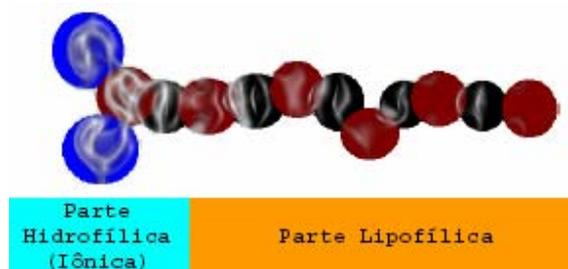
**Figura 1.** Representação esquemática de um surfactante. (DHAYMERS, 2005).
