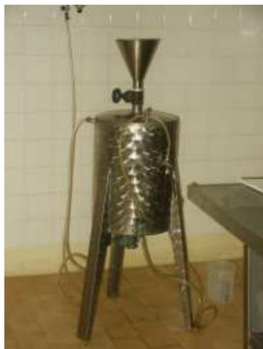
Figura 4 – Injetora – marca POWER, capacidade 50 L
