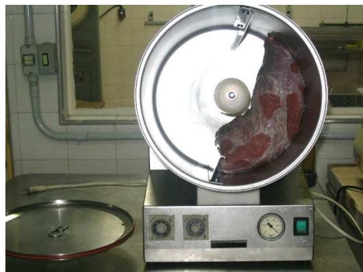
Figura 6 – Tumbler a vácuo – DORIT, modelo MGH-20, não refrigerado
