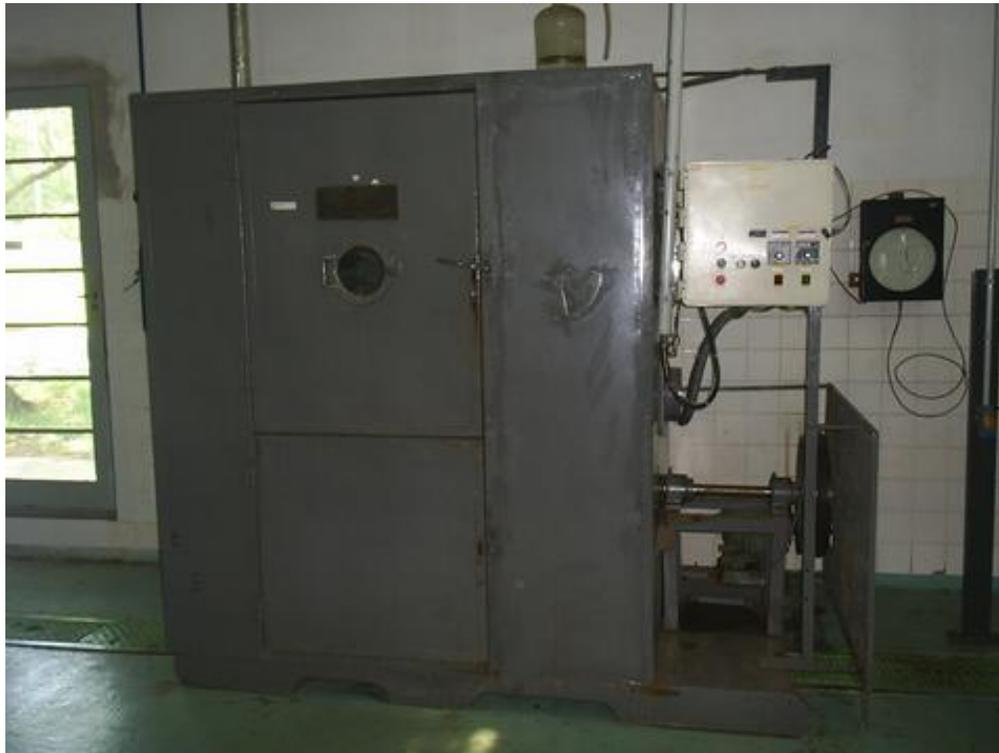
Figura 3.6 Secador de Bandejas Proctor & Schwartz- Planta de Operações Unitárias-ITAL
