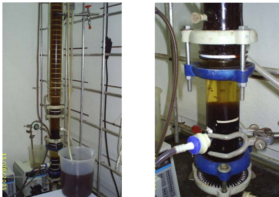
Figura 6.23. Experimento de desacidificação de óleo bruto de algodão na PRDC
