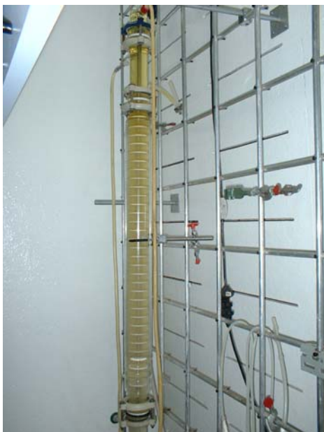
Figura 5.2. Fotos da PRDC presente no EXTRAE e utilizado como equipamento para desacidificação de óleos vegetais por extração líquido-líquido.
