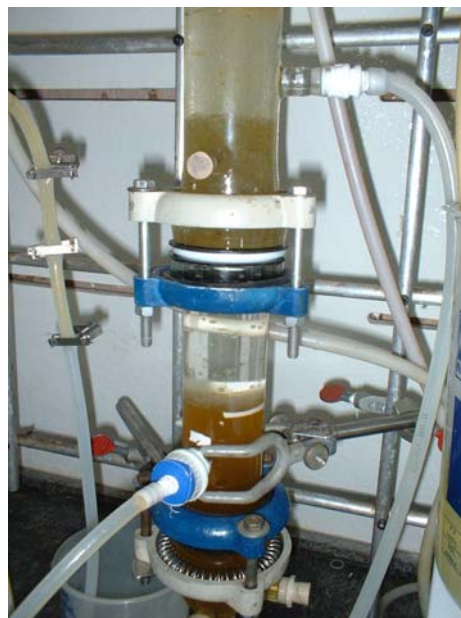
Figura 5.2. Fotos da PRDC presente no EXTRAE e utilizado como equipamento para desacidificação de óleos vegetais por extração líquido-líquido.
