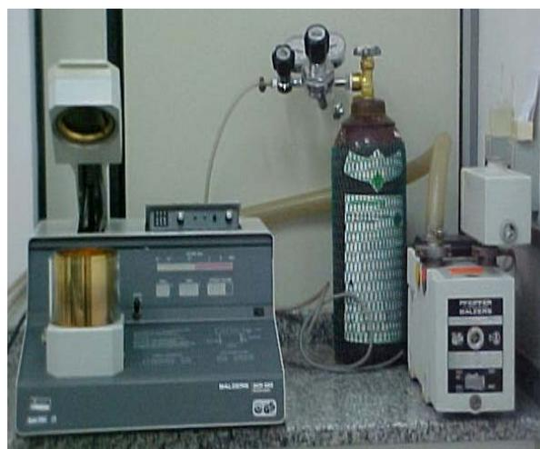
Figura 13: Equipamento Sputter Coater SCD 050.
