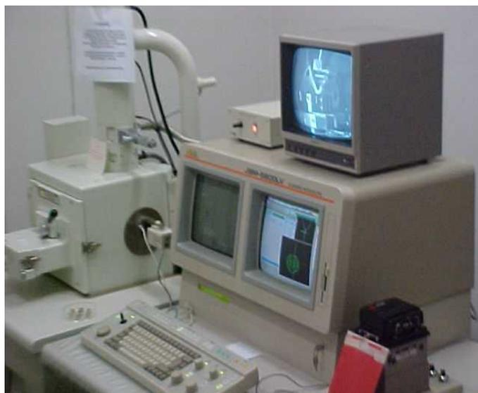
Figura 14: Microscópio Eletrônico de Varredura JEOL Modelo JSM 5800 LV.
