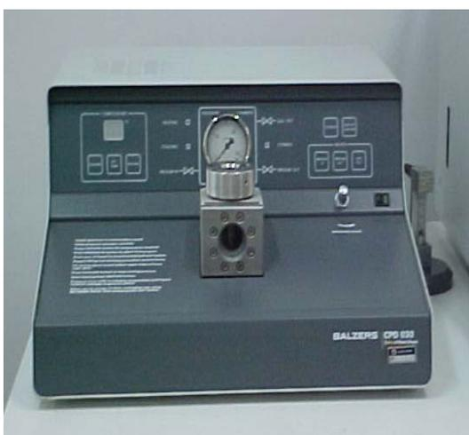
Figura 12: Equipamento Critical Point Dryer – Modelo CPD 030.
