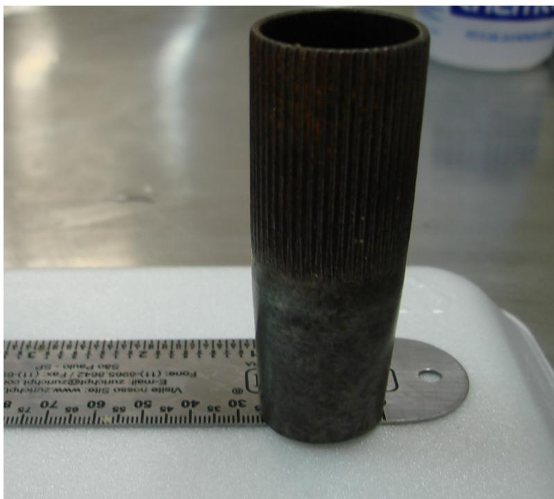
**Figura 1.** Cilindro utilizado para o preparo das amostras da análise de TPA.
