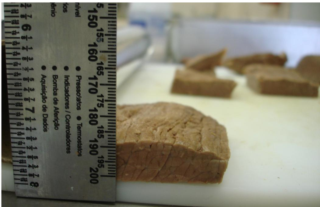
**Figura 4.** Detalhe da espessura da amostra do m. Peitoral profundo para o teste de Força de Cisalhamento no TA-XT2i.
