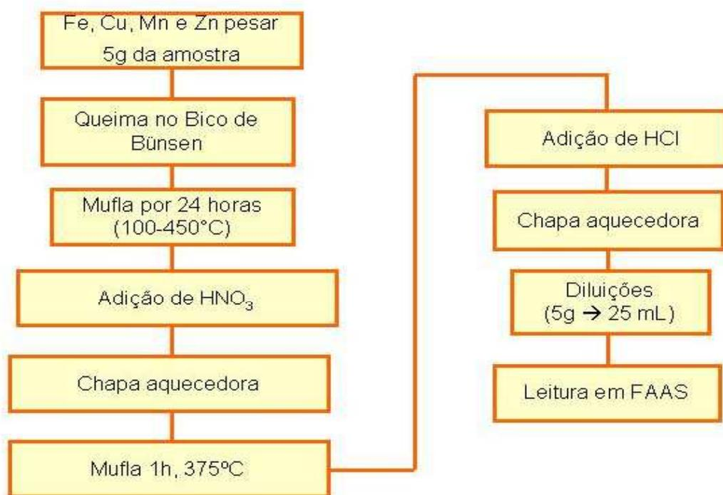
**Figura 2:** Fluxograma para determinação de Cu, Fe, Mn e Zn
