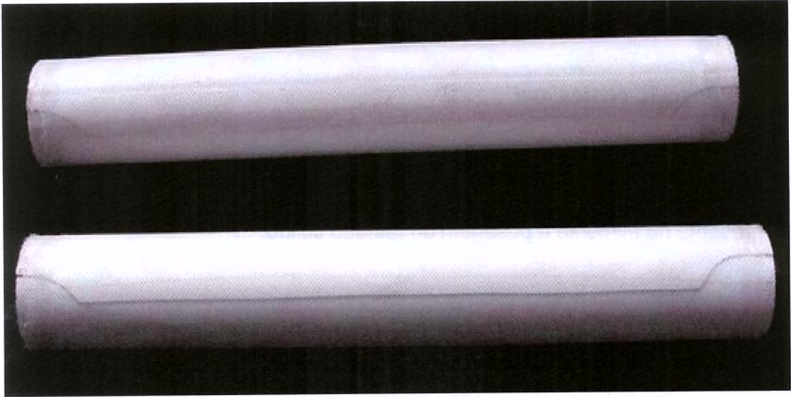
FIGURA 2.6 – Membranas poliméricas utilizadas para promover a separação das micelas de caseína das proteínas do soro no leite bovino.
