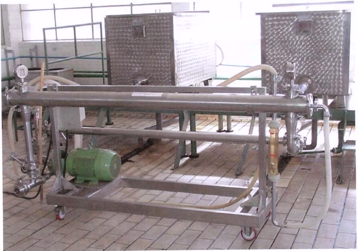
FIGURA 2.7 - Equipamento utilizado para promover a etapa de microfiltração na obtenção das micelas de caseína.
