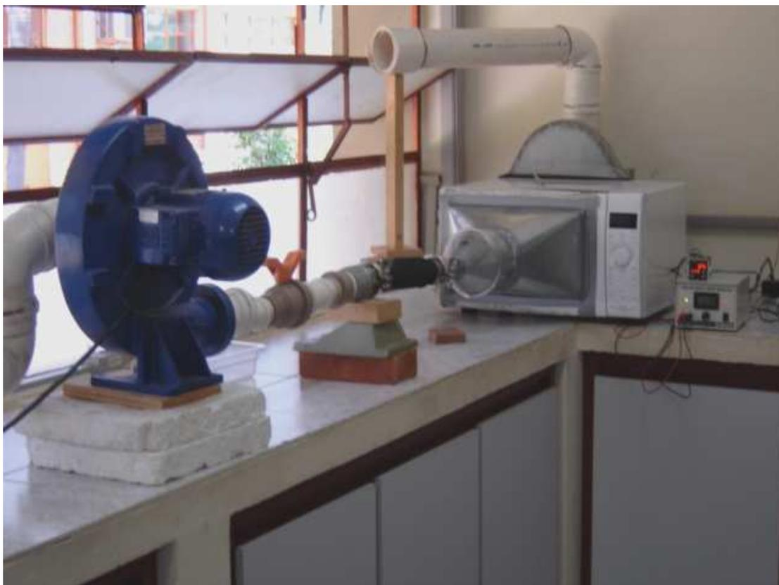
**Figura 6** – Forno de microondas doméstico Adaptado
