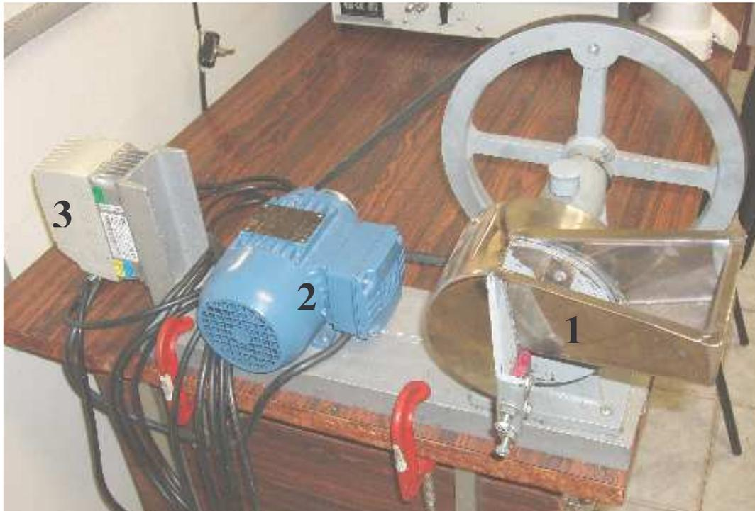
**Figura 4** – Quebrador de noz macadâmia: (1) alimentação; (2) motor; (3) controle de rotação
