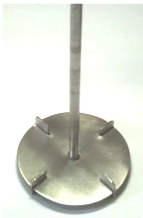
Figura 4.3. Turbina utilizada para agitar a solução osmótica.
