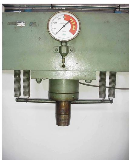
**FIGURA 2.** Detalhe do cabeçote da prensa utilizada na prensagem do café.
