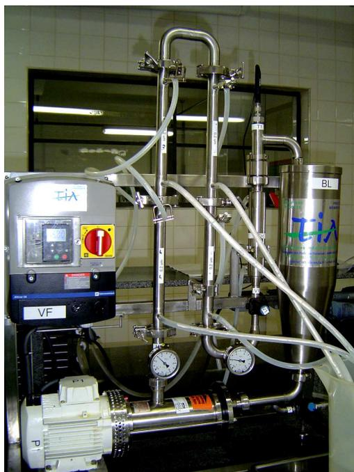
**Figura 7.** Equipamento piloto utilizado nos ensaios de ultrafiltração.
