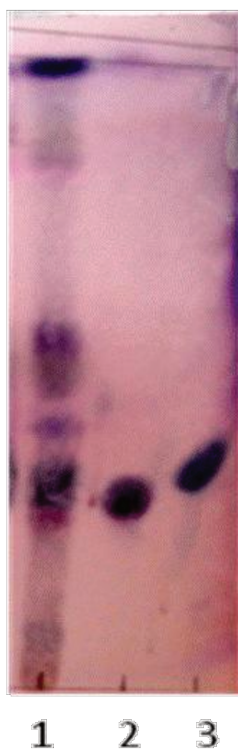
Figura 4.24: CCD para de detecção de óleos voláteis presentes no extrato (1) SFE (40 °C/150 bar) de ginseng brasileiro e comparação com os padrões comerciais (2) \beta -sitosterol e (3) estigmasterol em termos de coloração das bandas e Rfs.
