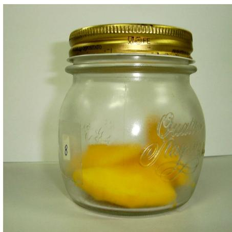
**Figura 3.2.** Recipientes herméticos utilizados nos ensaios para determinação da taxa respiratória.
