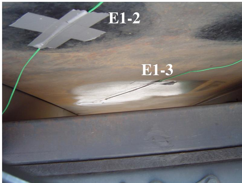
*Figura 87 Fixação dos sensores externos E1-2 e E1-3 no piso da carroceria*
