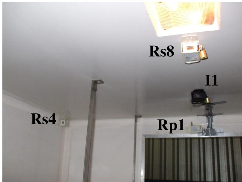
*Figura 89 Fixação dos sensores RP1, RS4, RS8 e do data-logger I1, no compartimento de resfriados.*
