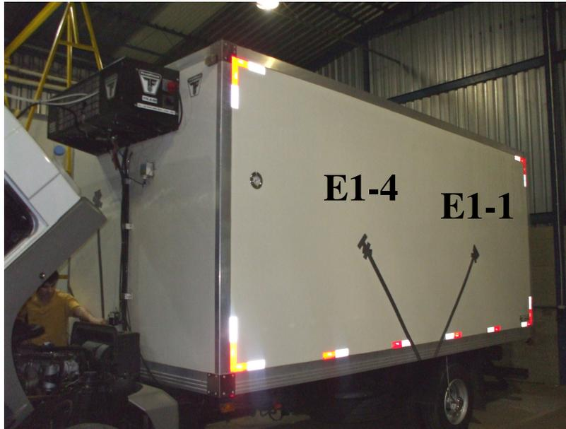
*Figura 86 Fixação dos termopares E1-1 e E1-4 na superfície externa da carroceria*
