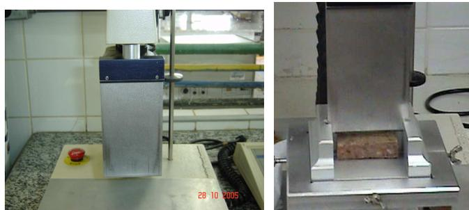
**Figura 6.** Célula de corte plano acoplada ao texturômetro.
