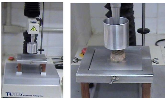
**Figura 5.** Probe P50 utilizado para a análise do perfil de textura.
