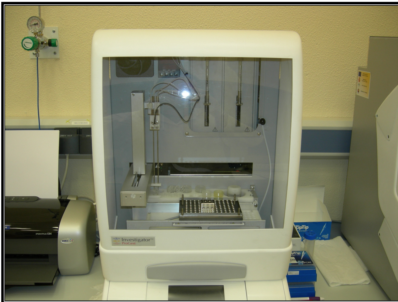
Figura 4. Braço robô utilizado para digestão e preparo das amostras para espectrometria de massas.
