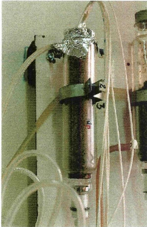
**Figura 3.5.** Reator de coluna instrumentado para a medição da temperatura do leito, conforme o descrito no item 3.16.
