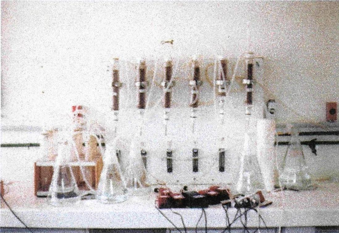
**Figura 3.2.** Montagem experimental dos reatores de coluna em funcionamento.
