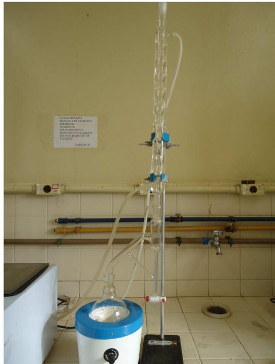
**Figura 4.2.** Aparato utilizado para avaliação de retenção de óleo
