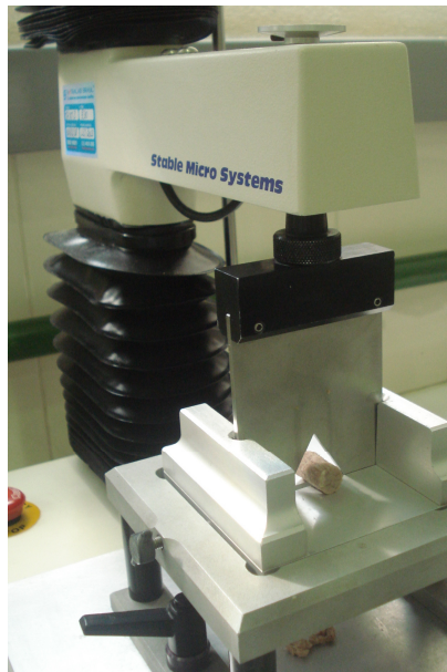
Figura 12 - Texturômetro Instron TA-XT 2i com o acessório Warner-Bratzler e corpo de prova posicionados.
