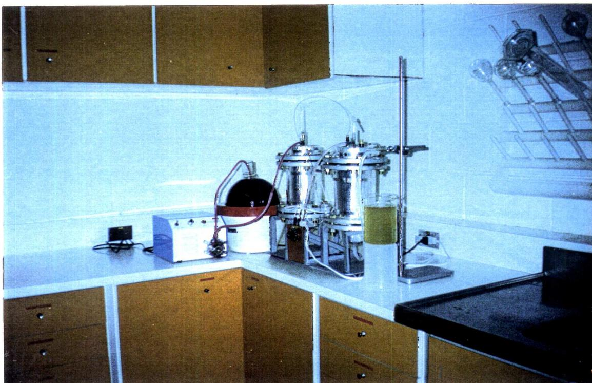
**Figura 4 - Colunas de carvão com sistema isolante**
