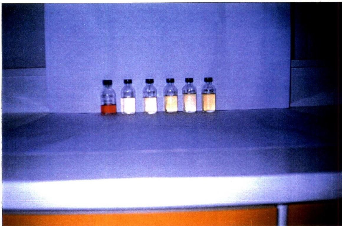
**Figura 9 - Aspecto visual do descoramento da calda a 55° Brix, pH 4,5 e temperatura de 80°C. Na ordem da esquerda para a direita: calda inicial, caldas com taxas de aplicação de 2,5 bv, 4 bv, 5 bv, 8 bv, 10 bv.**
