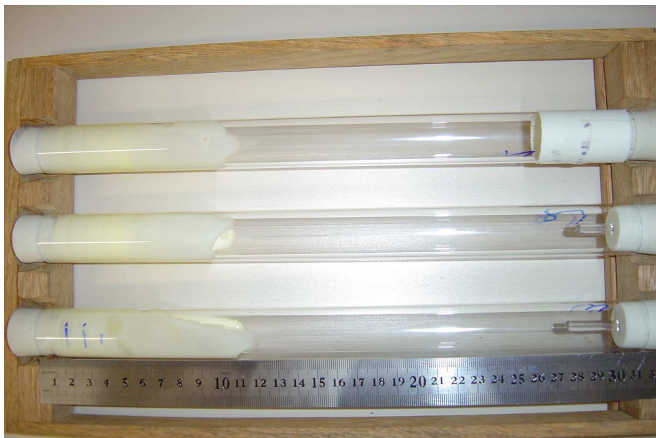
Figura 01. Estrado de madeira com os três tubos de vidro (31,0cm de comprimento e 30,0mm de diâmetro) para medir o fluxo de queijo dos requeijões.
