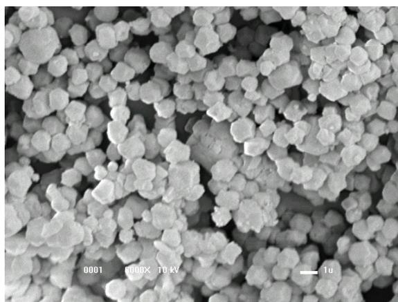
Microscopia eletrônica de varredura de amostras de amido antes da gelatinização com aumento de 6000 x
