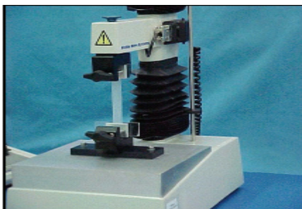
Figura 5.2.3. Filme de quinoa em teste de tração no Texturômetro TA.XT2i.
