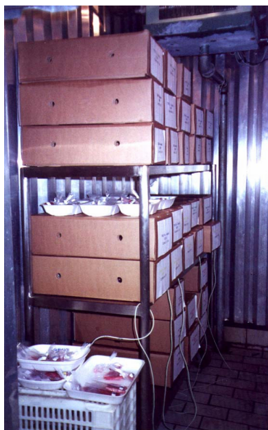
Figura 10 - Câmara de maturação monitorada por registrador de temperatura contendo as caixas de papelão com as porções dos músculos experimentais.
