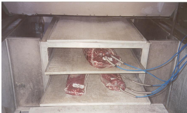
Figura 9 - Vista das bandejas do túnel de congelamento com os cortes dos músculos CF e FM embalados à vácuo e com os termopares inseridos na parte central e superfície.
