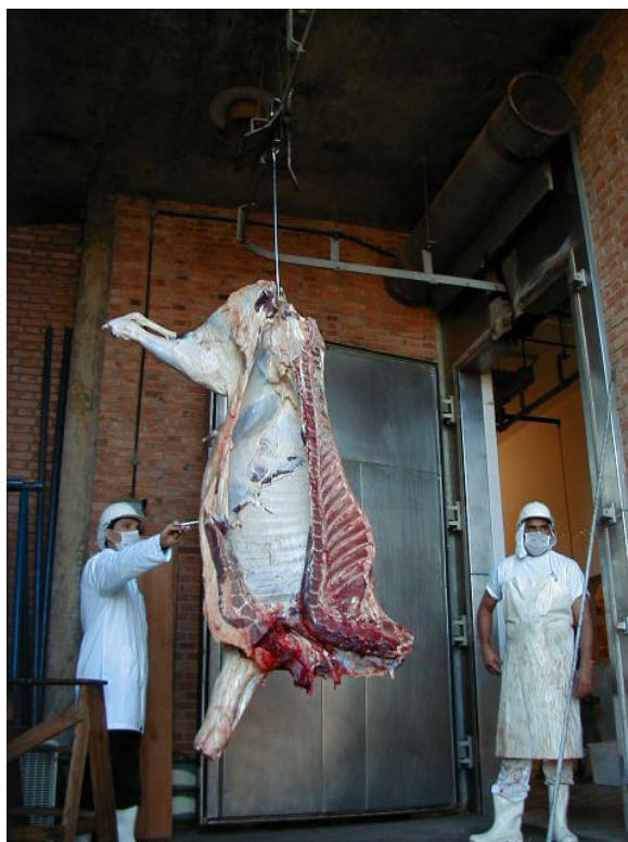
Figura 5 - Pendura da meia carcaça pelo osso pélvico utilizando carretilha com haste prolongada e talha elétrica.
