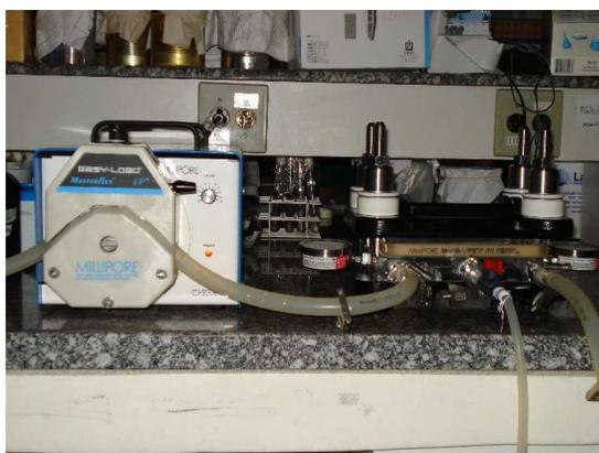
Figura 01 – Imagem ilustrativa do sistema de ultrafiltração.
