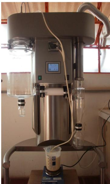
Figura 4.2 Spray Dryer utilizado nos ensaios de secagem.
