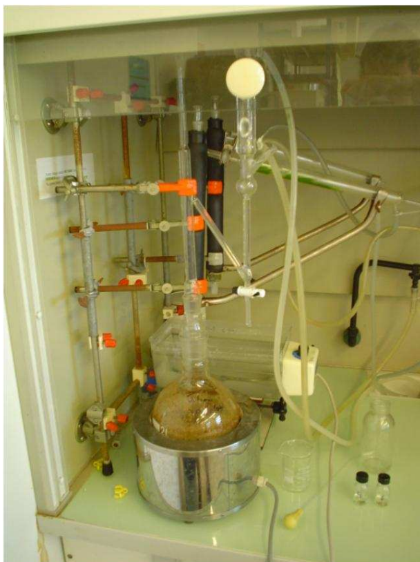
Equipamento 1. Sistema de hidrodestilação para obtenção de óleo de vetiver
