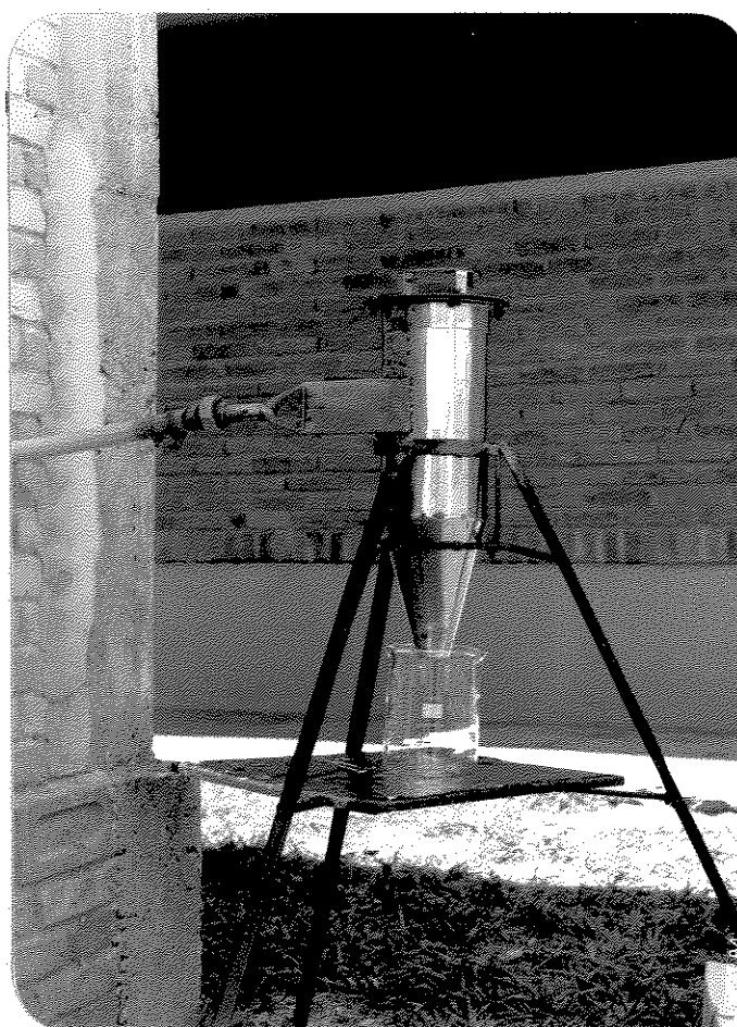
FIG. 05 CICLONE SEPARADOR UTILIZADO NO PROCESSO DE EXPLOÇÃO-AUTOHIDRÓLISE.
