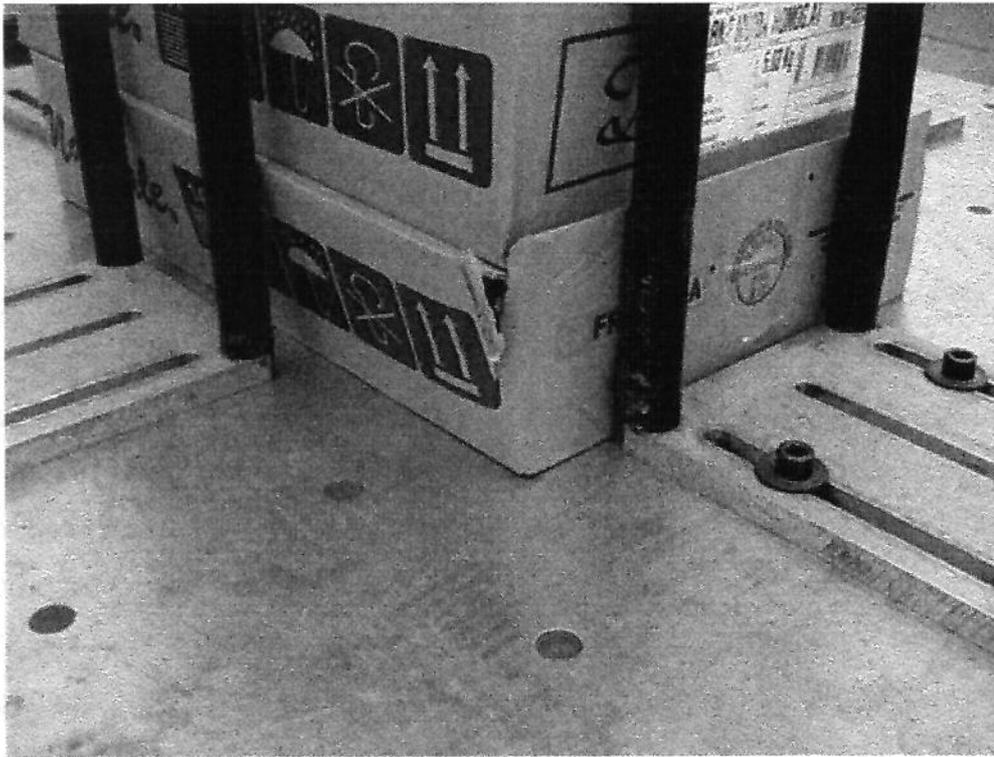
**FIGURA 4.1.** Danos causados nas caixas de papelão durante o teste de simulação de transporte das embalagens com ATM para carne moída – Frigorífico A.
