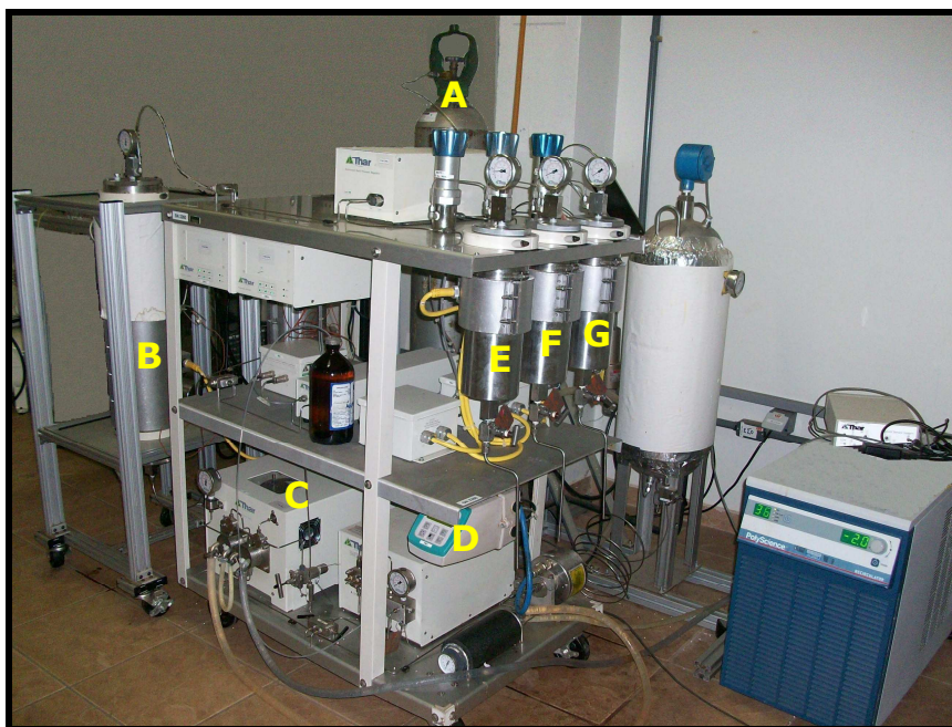
Figura 17. Unidade de extração por fluido supercrítico em escala piloto (Thar Technologies).
