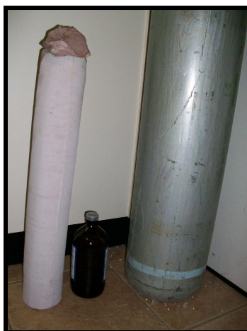
Figura 30. Comparação visual de tamanho do leito empacotado após extração com frasco de solvente e cilindro de gás.
