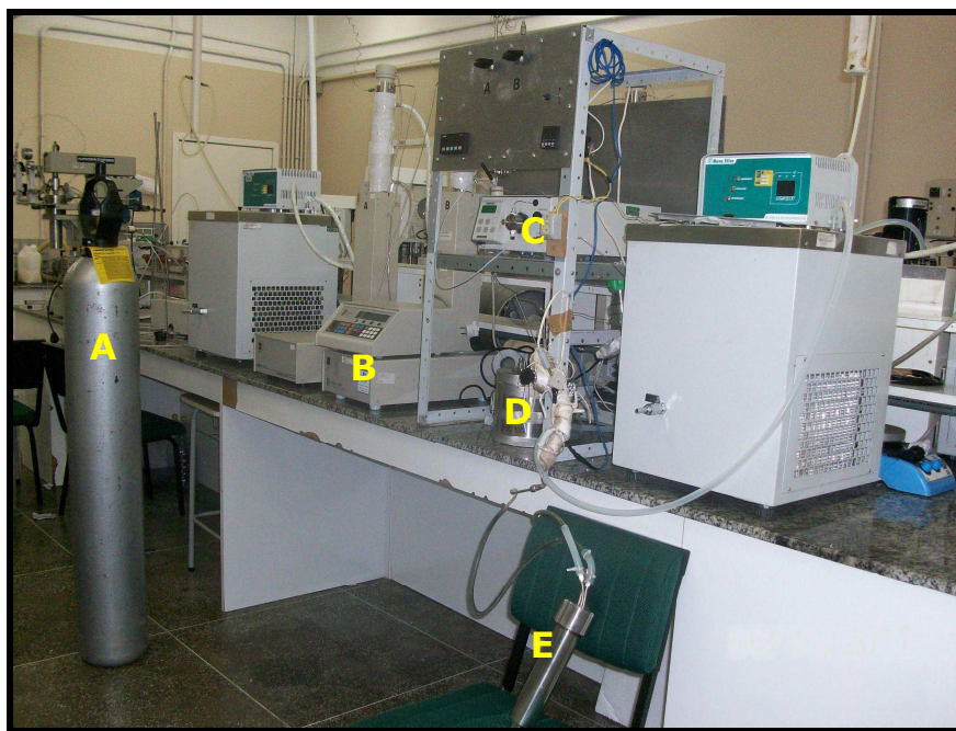
Figura 28. Foto real da unidade experimental empregando a técnica SEDS.
