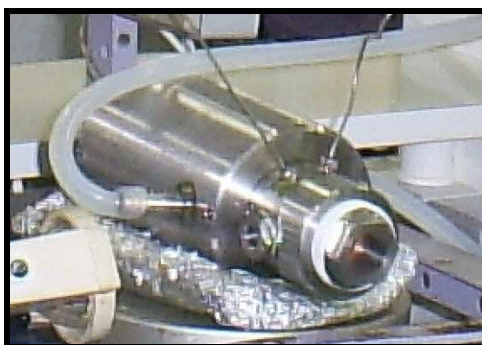
Figura 20. Célula de equilíbrio de volume variável montada para experimento (CANZIANI, 2008).
