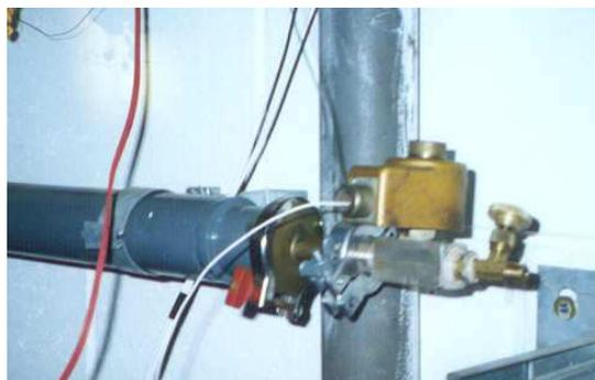
Figura 1.9 - Instalação da válvula solenóide.
