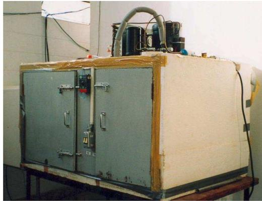
Figura 2.7 – Câmara de condicionamento da temperatura das amostras.
