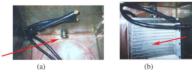
Figura 1.6 - (a) Detalhe do flange soldado para o trocador. (b) Trocador instalado dentro da câmara.
