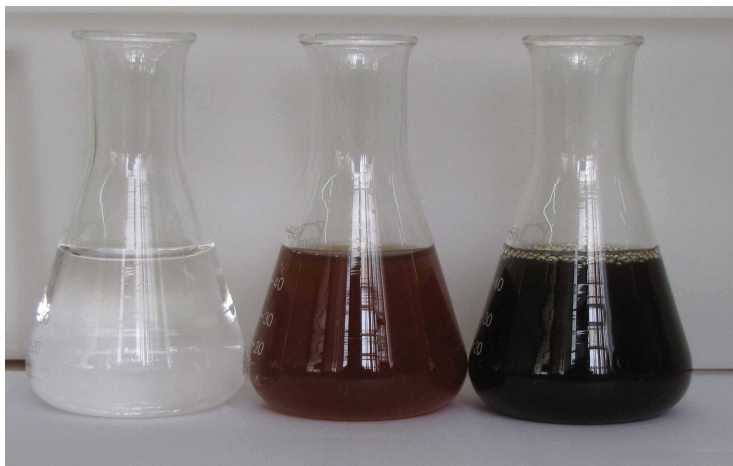
Figura 5.11. Produtos obtidos no processo de nanofiltração (pH 7,7; 8,7 bar e 30°C). Da esquerda para direita: Permeado, Extrato Inicial e Concentrado, respectivamente
