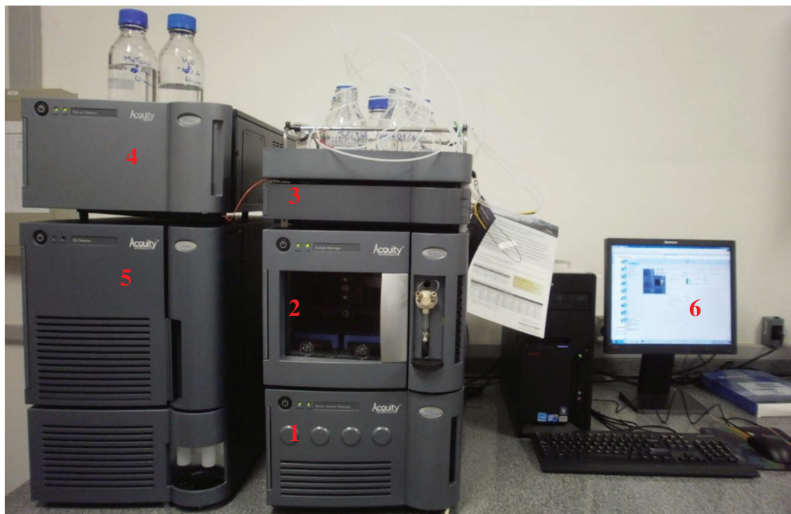
Figura 4.9 - Sistema de cromatografia líquida de ultra eficiência/ espectrômetro de massas utilizado nos experimentos. Legenda: 1 – Sistema de bombeamento, 2 – amostrador, 3- compartimento da coluna, 4 – detector de arranjo de diodos, 5 - espectrômetro de massas do tipo quadrupolo, 6 – sistema de aquisição de dados.
