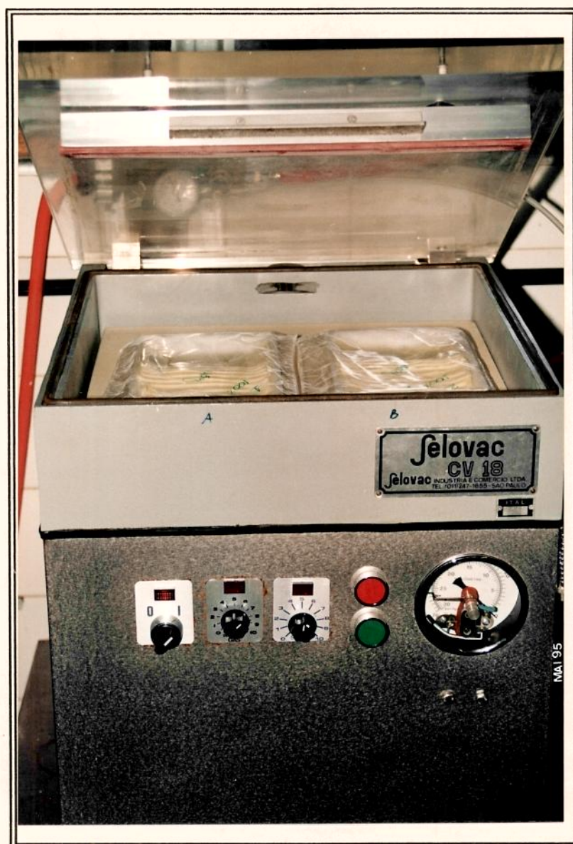
FIGURA 6. Equipamento utilizado no acondicionamento de queijo Mozzarella em embalagens com atmosfera modificada e a vácuo.
