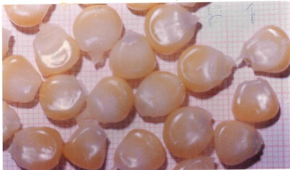
Figura IV.11 Fotografias do ensaio de secagem a 60°C para o milho normal no tempo 0, 1 e 8 h.
