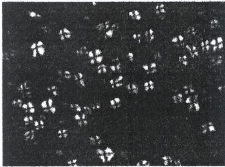
Figura.17: Microscopia ótica dos amidos de mandioca e de milho ceroso in natura , sob luz polarizada (a) e sob luz sem interferências (b).
