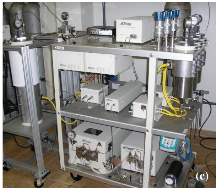
Figura 3.3. Unidades de extração supercrítica utilizadas no estudo. SFE-II (a), SFE-I e SFE-Ii (b) e piloto (c).
