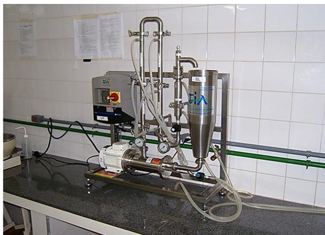
**Figura 22: Equipamento micropiloto de microfiltração.**
