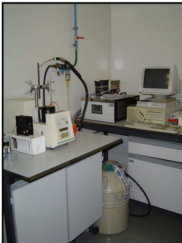
Figura 3.4: Foto do calorímetro da *Shimadzu Corp.* (modelo DSC-50) usado em Portugal.
