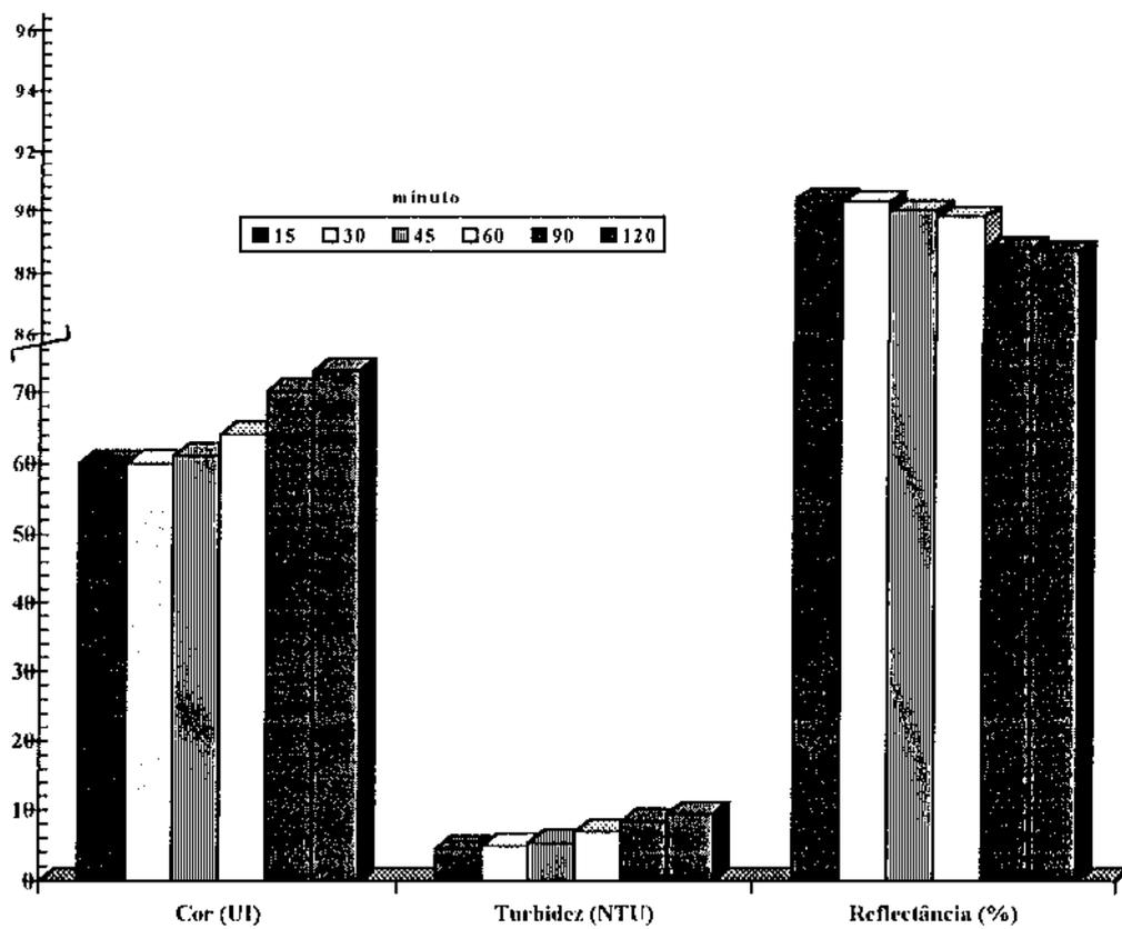
**Figura 8b.** Efeito do tempo de agitação no rendimento da nucleação e características do açúcar obtido, em solução hidroalcoólica 80 °INPM
