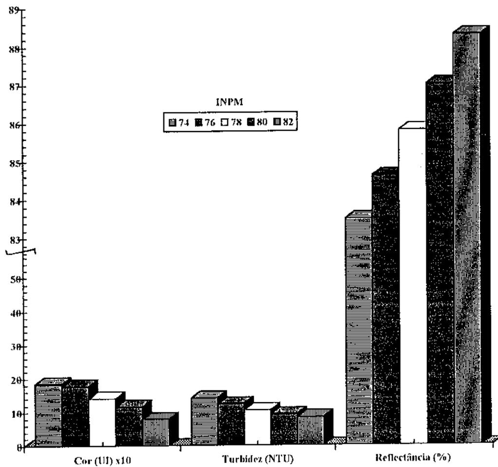
Figura 7b. Efeito da concentração de etanol na qualidade do açúcar obtido
