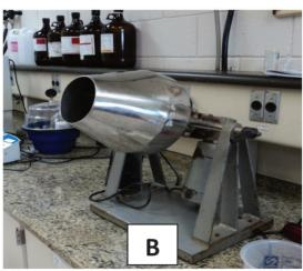
**Figura 1.** Sistema de revestimento da ração por aspersão (A) vista frontal e (B) vista lateral.
