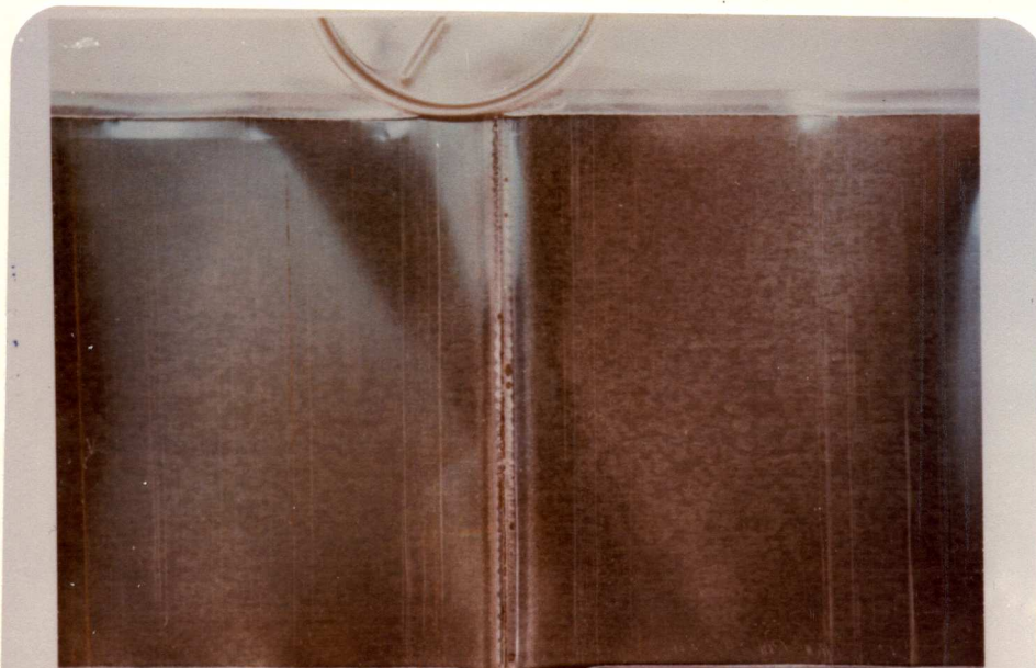
FIGURA 46 - Latas B aos 150 dias de estocagem a 35°C. Diferenças na in- tensidade de cor- rosão.
