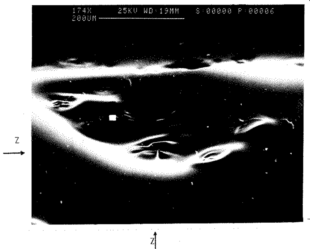
FIGURA 30 - Micrografia com maior aumento da região marcada pelas flechas Y na Figura 23. Embora a região marcada pelas flechas Z nessa Figura tenha a aparência de uma fratura do verniz, provavelmente a primeira camada de verniz continua íntegra, conforme verificado na sua microanálise pontual (Figura 31).
