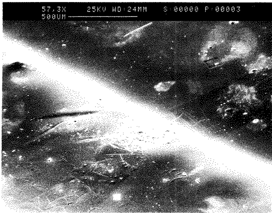
FIGURA 38 - Micrografia da região de soldagem da amostra D a zero dia de estocagem. A Figura 39 mostra a microanálise superficial (o marcador não tem qualquer sentido nessa foto). Verifica-se a presença predominante de cloro, devido ao verniz. A presença de cobre pode ser devido a contaminação no processo de soldagem.
