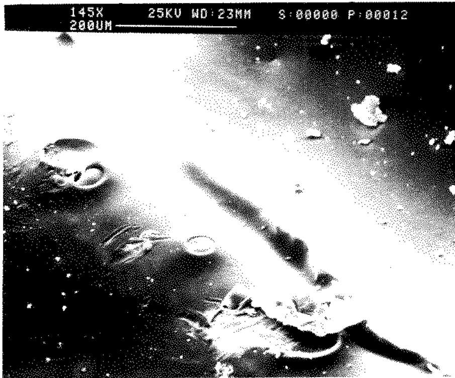
FIGURA 8 - Micrografia da região demarcada pelas flechas X na Figura 7 com maior aumento. Verifica-se o rompimento da bolha de verniz, sendo que este não foi destacado completamente. A microanálise pontual (Figura 9) confirma a falta de verniz, pela baixa quantidade de Cl e alta de Fe.
