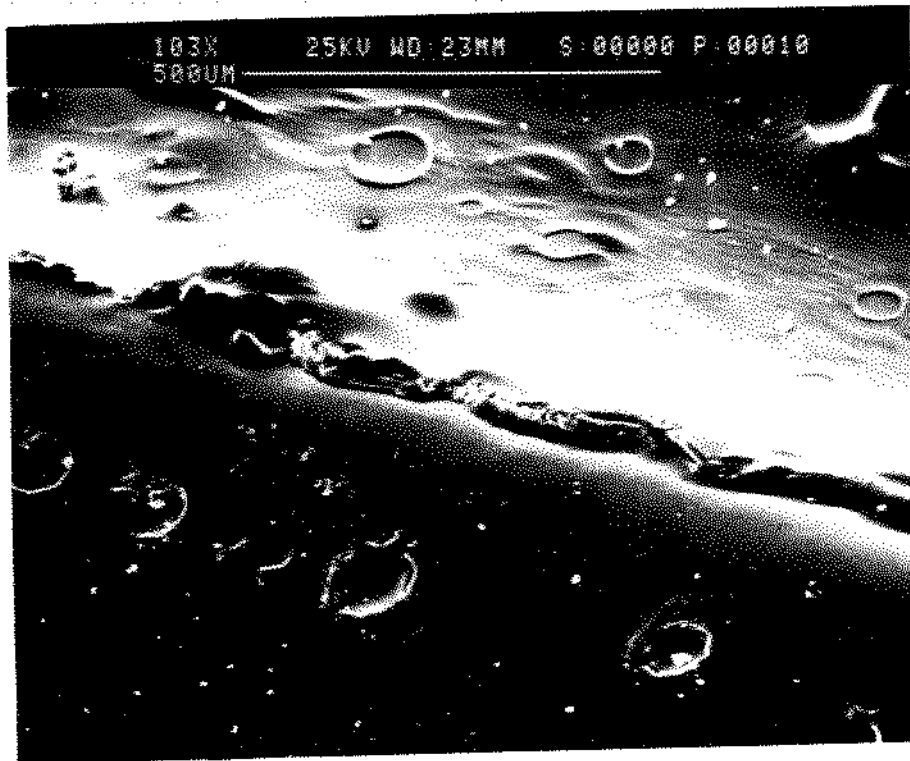
FIGURA 5 - Micrografia de uma região da amostra A a zero dia onde se verifica uma fratura do verniz no degrau formado na região de soldagem. A microanálise dessa região (Figura 6) também mostra a presença de Pb, proveniente da solda Sn/Pb.
