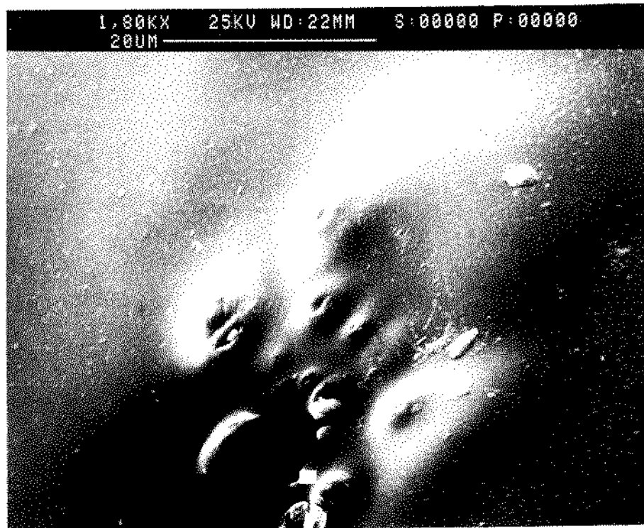
FIGURA 43 - Micrografia da amostra da região de soldagem da lata D aos 180 dias de estocagem. Verifica-se a presença de bolhas no verniz. A Figura 44 mostra a microanálise pontual em um poro aparente. Verifica-se que a proteção do verniz é mantida, pelas quantidades relativas do cloro, estanho e ferro. Nessa região há a presença de estanho o que não acontecia na análise sobre a solda pelo fato desse metal ser retirado no processo.
