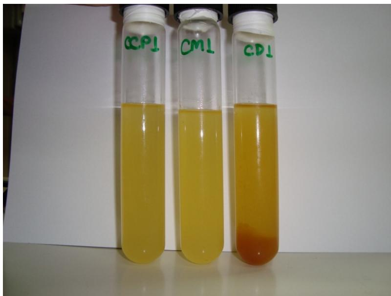
Figura 38. Organogéis com 1% (m/m) estruturados com cera de cana de açúcar (CCP1) e suas frações cera mole (CM1) e cera dura (CD1) cristalizados em 25°C, após 3 dias de estocagem a 25°C.
