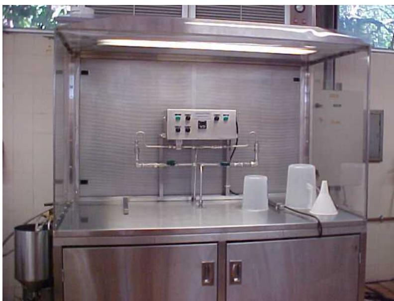
Figura 3.5. Câmara de fluxo laminar para envase asséptico com controle automático do enchimento.
