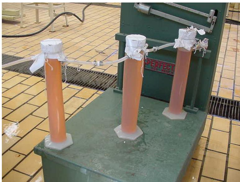
Figura 3.4. Recolhimento do permeado da microfiltração em sistema fechado
