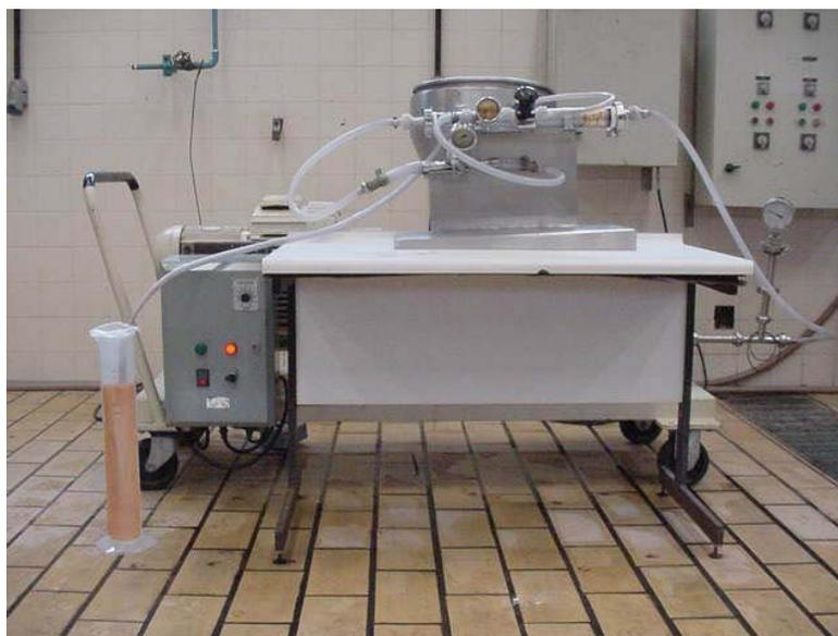
Figura 3.2. Unidade de microfiltração Protosep IV
