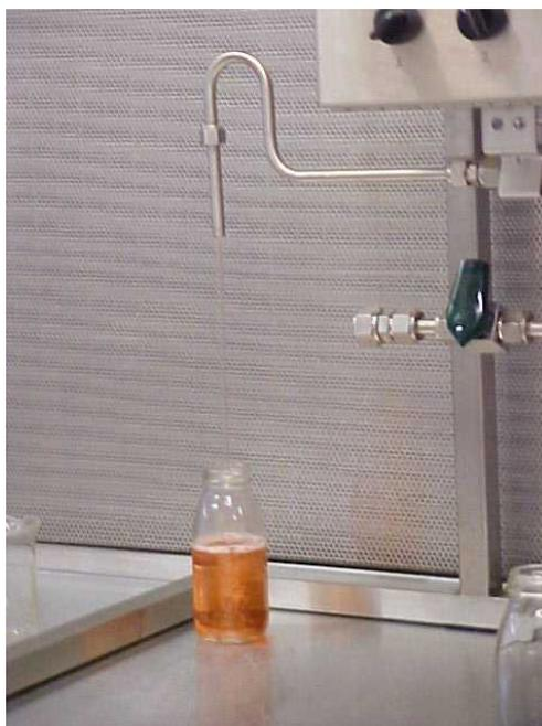
Figura 3.10. Envase contínuo na câmara de fluxo laminar para envase asséptico com controle automático de enchimento.
