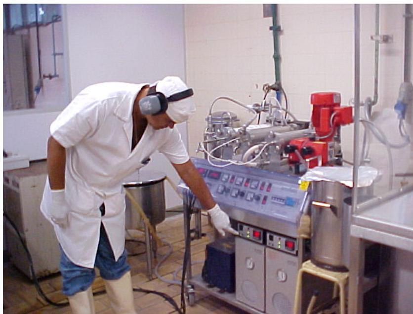
Figura 3.9. Esterilização em trocador de calor de superfície raspada
