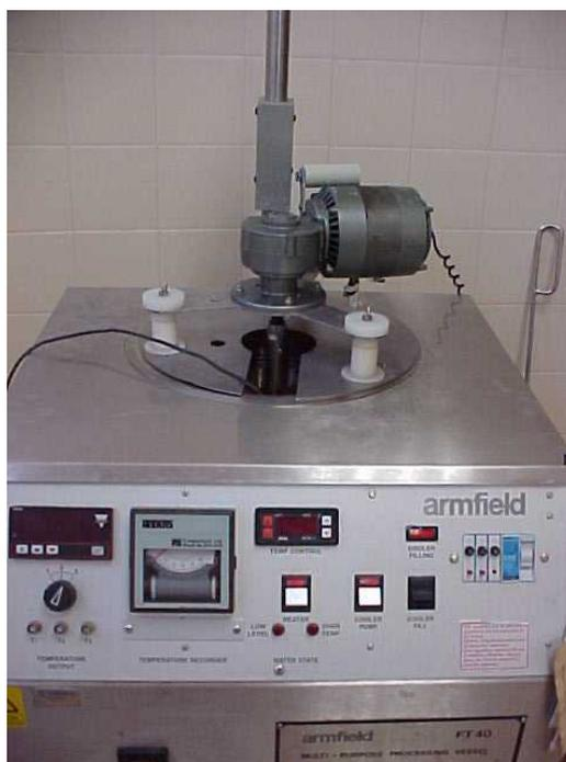
Figura 3.1. Vaso multipropósito da Armfield, utilizado para o tratamento enzimático da polpa de acerola
