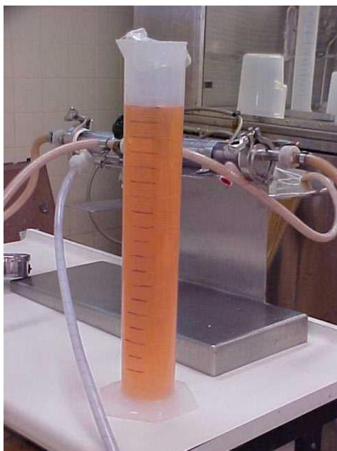
Figura 3.8. Microfiltração da mistura de sucos e água com recolhimento do permeado em sistema aberto, para o processo C
