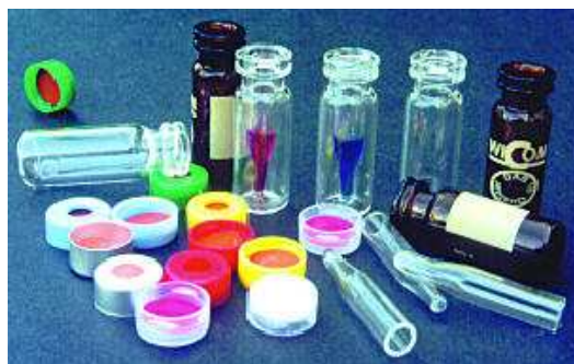
Figura 23: Adaptador utilizado para injeção automática de micro amostras, em cromatografia gasosa.
