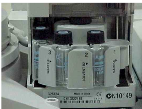
Figura 22: Sistema para automação das injeções em cromatografia gasosa.
