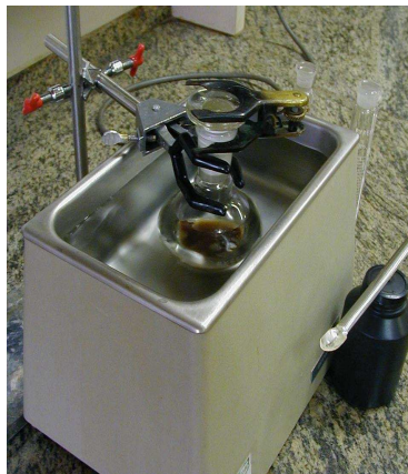
Figura 33: Ilustração de um banho de ultra som para extração, utilizando-se microcápsulas de café, clorofórmio e água.
