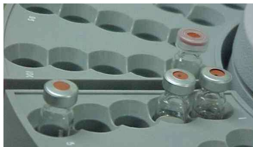
Figura 22: Sistema para automação das injeções em cromatografia gasosa.
