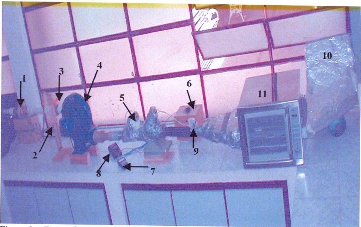
Figura 2 – Forno de secagem convencional adaptado a um sistema gerador de ar quente - (1) célula de fluxo laminar; (2) manômetro “U”; (3) válvula de esfera; (4) ventilador centrífugo do ar de entrada; (5) aquecedor por resistência elétrica; (6) controlador de temperatura; (7) termômetro digital c/ termopar; (8) registrador de temperatura; (9) abraçadeira de conexão do forno com o sistema de ar quente; (10) sistema para exaustão do ar; (11) forno doméstico.
