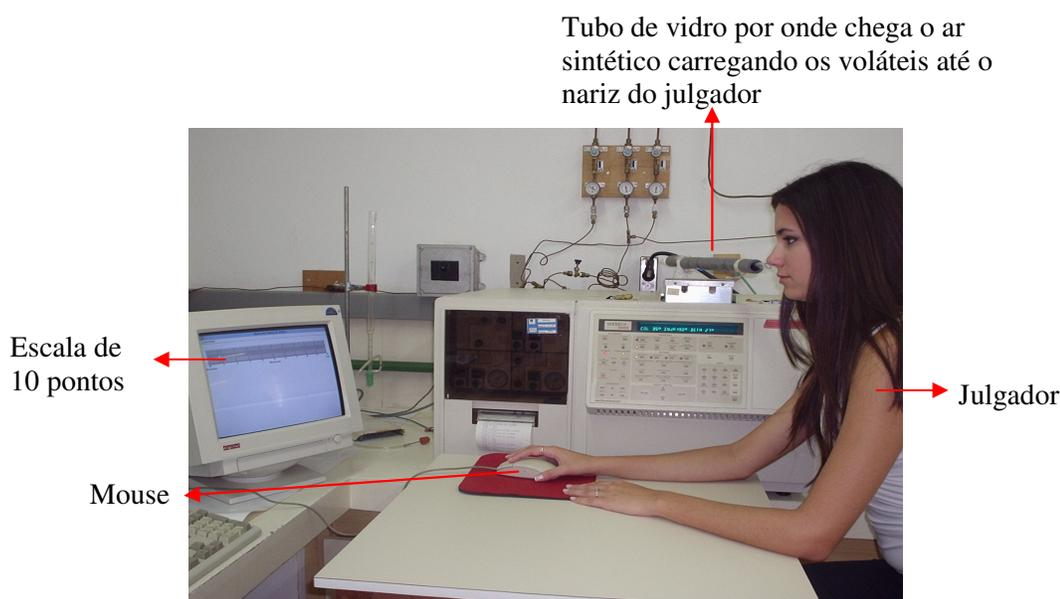
**Figura 11: Julgador realizando análise CG-olfatométrica de efluente cromatográfico através da técnica Osme. Laboratório Central Instrumental, Departamento de Alimentos e Nutrição, Faculdade de Engenharia de Alimentos, UNICAMP.**
