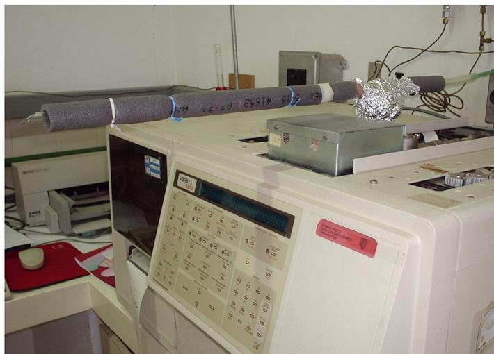
**Figura 9: Tubo de vidro coberto por manta e conectado à base do cromatógrafo gasoso.**
