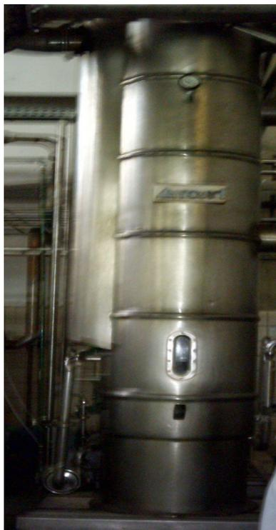
**Figura 2: Evaporador de filme descendente utilizado na concentração do suco de caju (Empresa A) que gerou a *water phase* utilizada na presente pesquisa.**
