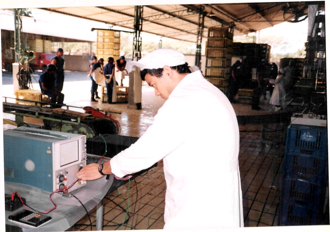
FIGURA 3. Medida da frequência e voltagem do atordoador elétrico.
