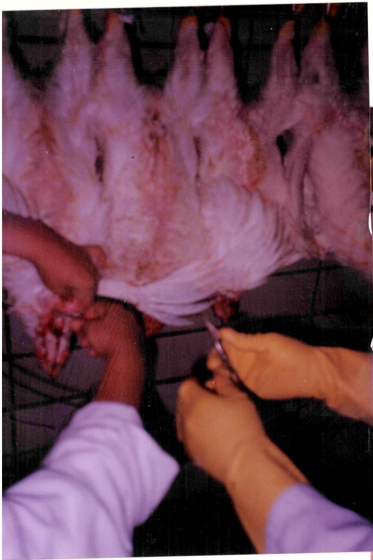
FIGURA 6. Aplicação do eletrodo positivo nas carcaças.
