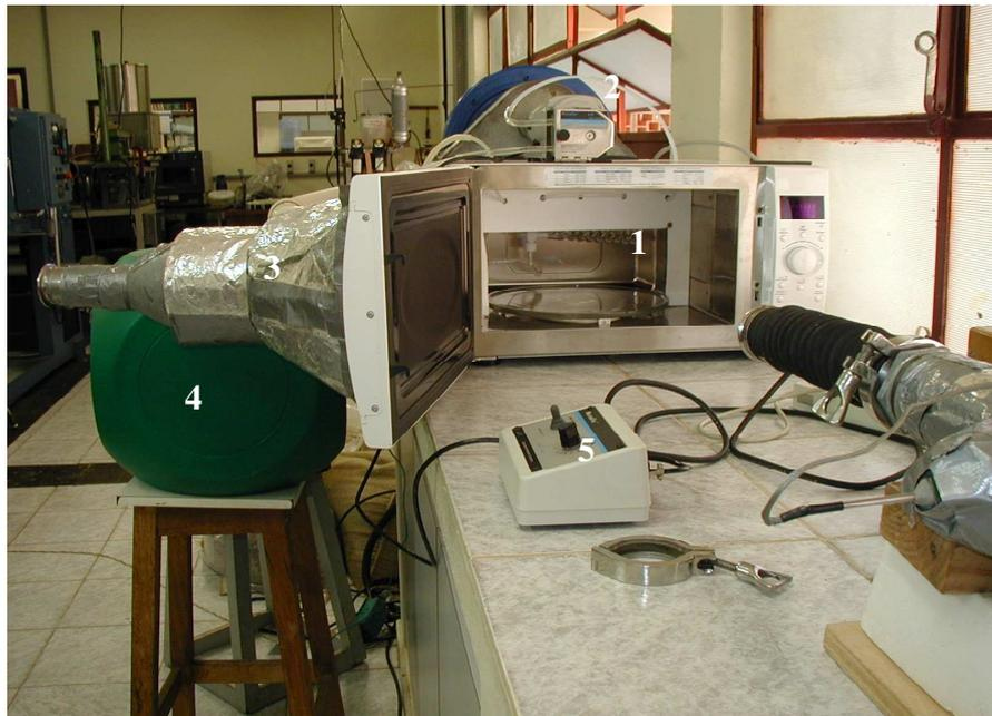
Figura 4.5: Forno doméstico de microondas com carga d'água adaptada – (1) serpentina de vidro e mangueiras de teflon, suportadas em uma estrutura de teflon; (2) bomba peristáltica; (3) difusor de ar quente sobre a porta do forno (4) bombonas de água; (5) controlador de vazão da bomba.
