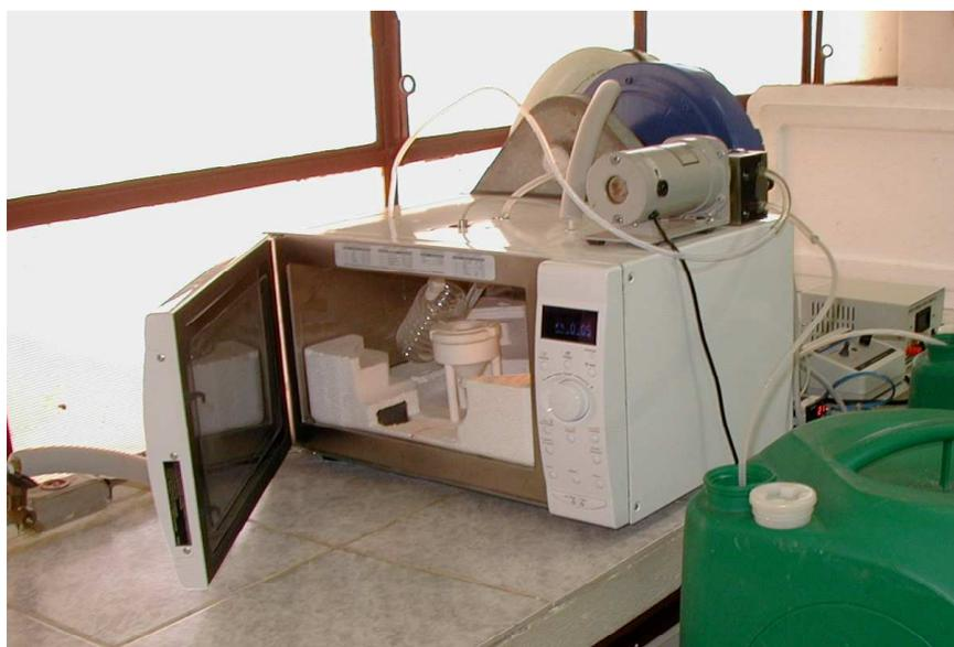
Figura 4.8: Foto do forno de microondas doméstico alojando o secador de leite fluidizado
