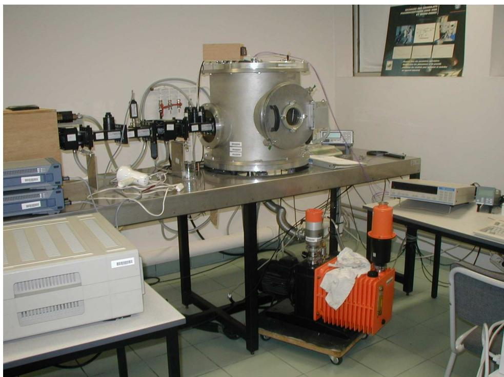
Figura 4.11: Foto do equipamento de secagem a vácuo com aplicação de microondas
